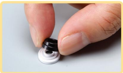
▲將白色墊片及黑色墊片如圖示重新組合在一起。白色墊片凸出處面向黑色墊片寬口處。
