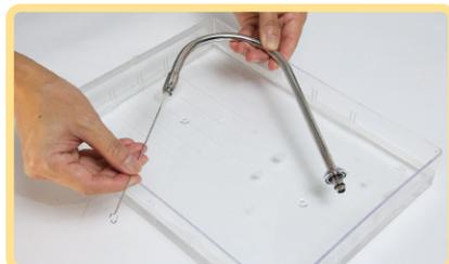
▲將噴嘴自清潔溶液中取出，以小孔刷刷洗噴嘴內外，再用清水沖洗，直到將清潔溶液完全沖洗乾淨為止。
