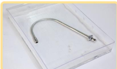
▲將噴嘴放入容器中，浸泡於清潔溶液（註\*）一個小時。
