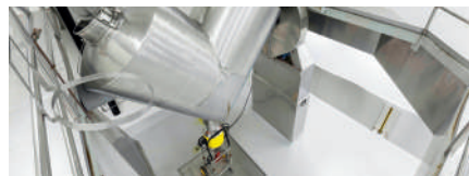
粉末經震盪式篩濾器分離成AB級營養成分。A級可直接使用；B級須再萃取。
